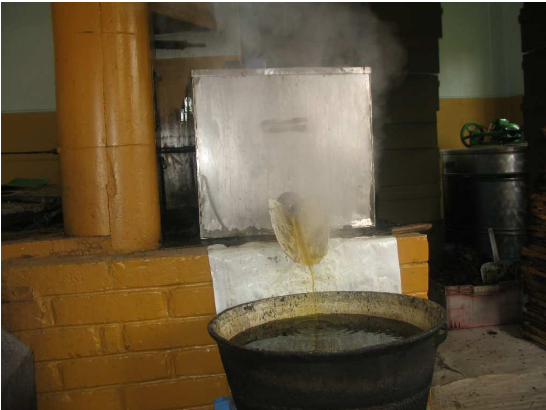
Fotod 3. Sulavaha väljavoolamine jahutuskatlasse
