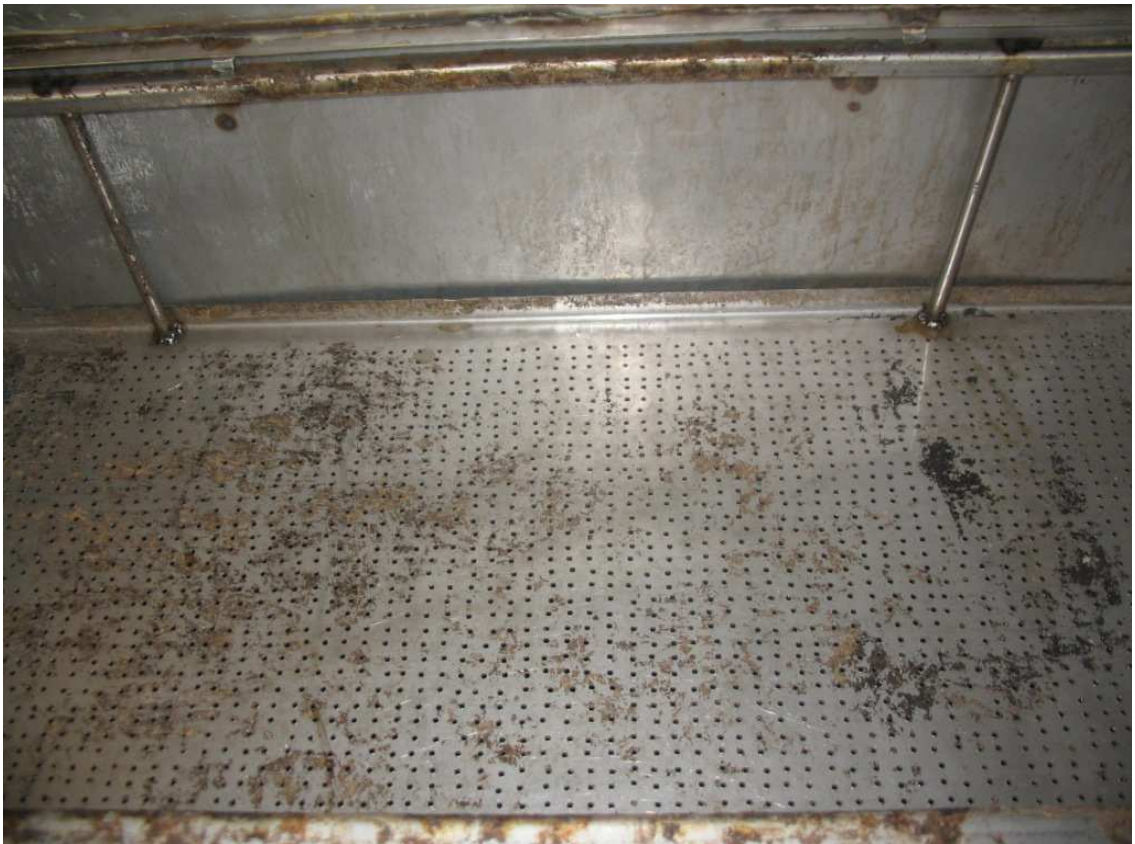
Fotod 2. Vahasulatuskasti välisvaade (näha on sulavaha väljavooluava) ja perforeeritud plekist valmistatud sisemise resti vaade.
