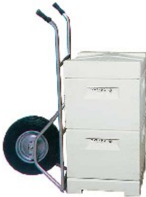
Joonis 16. Tarukäru korpustarule
